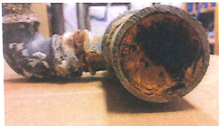
Yli 50 vuotta vanhat vesijohdot voivat kasvaa lähes umpeen ja heikentää veden laatua.
